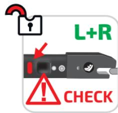
Τώρα περιστρέψτε το μοχλό στερέωσης ISOFIX (IE) ελαφρώς προς τα επάνω και σπρώξτε το κάθισμα μέχρι να φτάσει τέρμα πίσω στην πλάτη του καθίσματος του αυτοκινήτου. Αφήστε τους βραχίονες ISOFIX (IM) να κουμπώσουν στη θέση τους με ένα ήχο << κλίκ >>.
