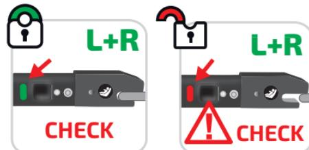
Drehen Sie nun den ISOFIX-Einstellhebel (**IE**) wieder leicht nach oben und drücken den Sitz soweit es geht an die Rückenlehne des Fahrzeugs. Lassen Sie die ISOFIX-Arme (**IM**) mit einem hörbaren <<click>> einrasten.
