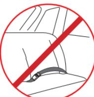
Der Sitz kann auf allen Beifahrer- und Rücksitzen des Fahrzeugs verwendet werden, die mit einem Dreipunktgurt ausgestattet sind. Der Sitz darf allerdings nicht auf dem mittleren Rücksitz nur mit dem Beckengurt verwendet werden!
