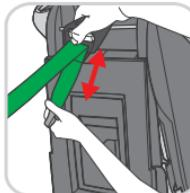
Στη συνέχεια πάρτε το Top Tether (TT) και οδηγήστε το κάτω από το προσκέφαλο στο κατάλληλο σημείο αγκύρωσης Top Tether του αυτοκινήτου. Αυτό μπορείτε να το βρείτε στο εγχειρίδιο οδηγιών του αυτοκινήτου.
