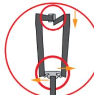
Um den Schrittgurt zu entfernen schieben Sie den Gurt zusammen mit der Metallplatte von unten nach oben aus dem Sitzteil. Den Zentralverstellgurt (**GS**) verstauen Sie unter der Einstellerabdeckung (**F**).
