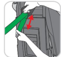
**ACHTUNG:** Wurde der Top Tether (**TT**) korrekt befestigt, erscheint am Sicherungsknopf eine grüne Markierung.
