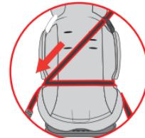
Koltuk, üç noktalı kemer ile donatılmış aracın tüm yolcu ve arka koltuklarında kullanılabilir. Ancak, koltuk orta arka koltukta sadece kucak kemeriyle kullanılamaz!
