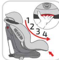
Πίεστε λίγο το παιδικό κάθισμα αυτοκινήτου μέσα στο κάθισμα του αυτοκινήτου και στη συνέχεια περιστρέψτε το μοχλό στερέωσης ISOFIX (IE) ελαφρώς προς τα επάνω για να χαλαρώσετε τα άγκιστρα ISOFIX (IK).
