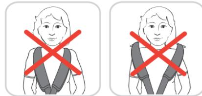
Bitte achten Sie darauf, dass die Gurte weder hinter dem Rücken des Kindes oder auf Höhe der Ohren verlaufen. Die Kopfstütze sollte so eingestellt sein, dass das integrierte 5-Punkt-Gurt-System (G) auf Schulterhöhe des Kindes verläuft.
