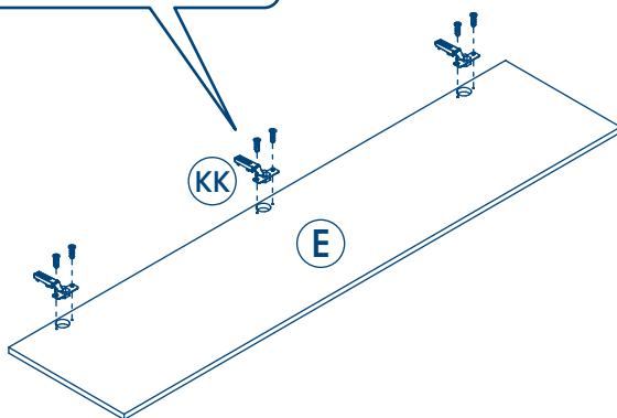
door alignment adjustment, ضبط محاذاة الباب, réglage de l'alignement de la porte, einstellvorrichtung für türpassung, ρύθμιση ευθυγράμμισης πόρτας, penyesuaian penyelarasan pintu, 도어 정렬 조정, 门对齐调整, dostosowanie linii drzwi, ajuste do alinhamento da porta, регулировка дверцы, ajuste de la alineación de la puerta, การปรับตัวแห่งประตู, kapi hizalama ayarlaması
