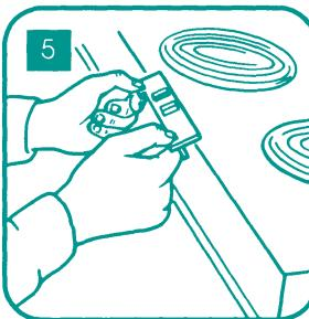
Introduzca las dos partes del Protector por el Soporte del Centro, y extiéndalas hasta que haya un solape por el Soporte del Centro de aproximadamente 3cmts. a ambos lados.
