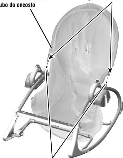
8 Side Rail Sockets Conexiones de las barandillas laterales Logements des montants latéraux Suquetes da barra lateral
